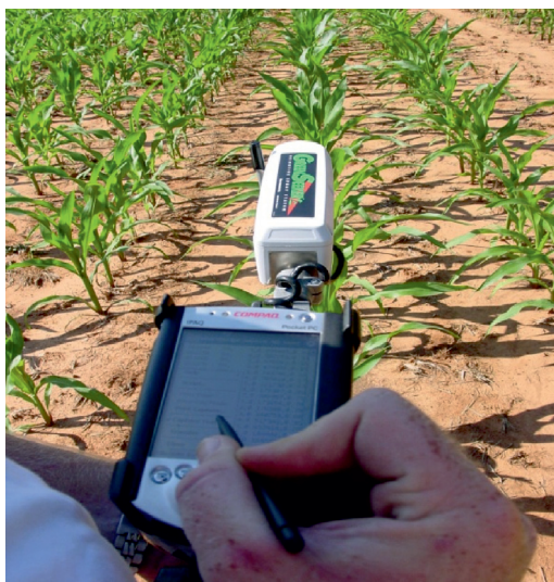
Rys. 3. Urządzenie do pomiaru wskaźników wegetacji (GreenSeeker, NTech Instruments Inc.) Źródło: Mikołowicz, 2008 (9)
