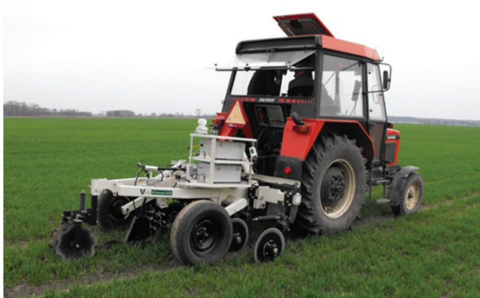
Fot. 1. Pomiar „on-the-go” właściwości spektralnych gleb mobilnym spektrofotometrem (VerisTech. USA)
