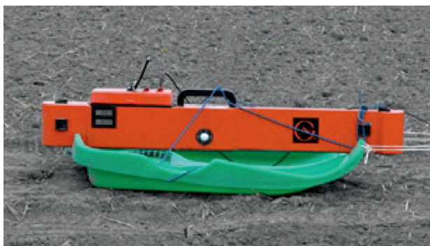
Fot. 2. Konduktometr EM 38 MK2 Geonics Ltd. (Canada) (fot. J. Niedźwiecki)
