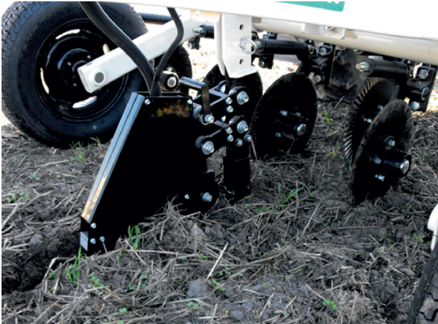
Fot. 5. Lemiesz z umieszczoną wewnątrz lampą halogenową podczas pomiarów spektralnych (fot. J. Niedźwiecki)
