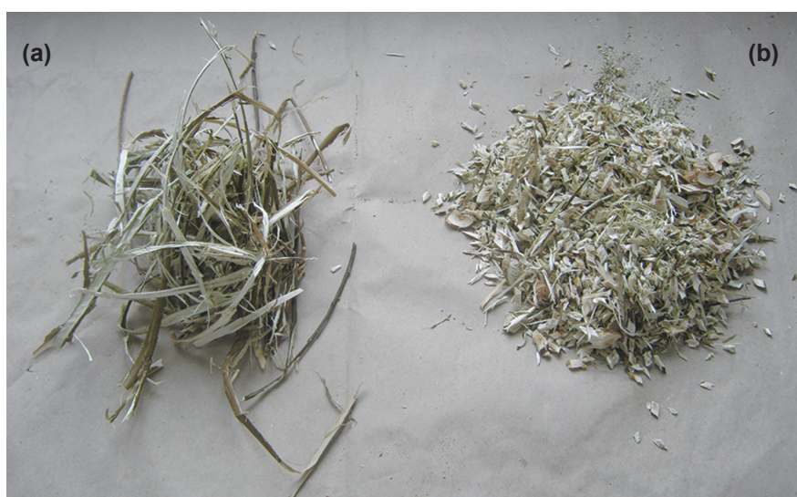
Fot. 6. Efekt zrębkowania cienkich (a) i grubych (b) pędów wierzby (A. Bochniarz)
