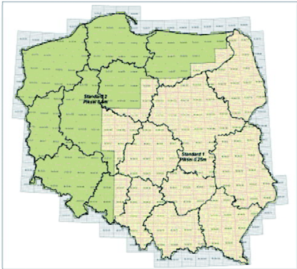
Rys. 2. Aktualny standard ortofotomapy przeznaczony dla aktualizacji baz danych LPIS Źródło: dane ARiMR, Warszawa.
