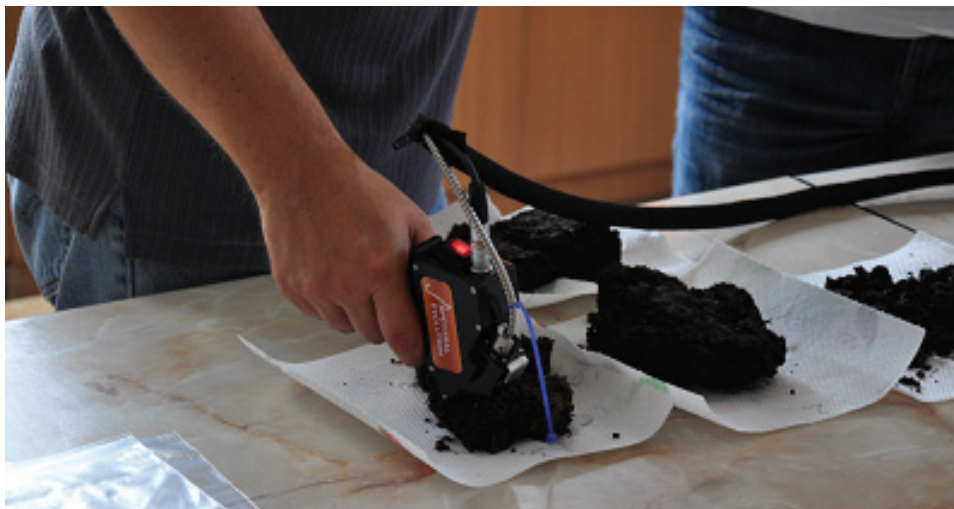
Rys. 3. Skanowanie próbek gleb organicznych przy pomocy spektroradiometru PSR-3500® (Spectral Evolution, Lawrence, MA, USA)
