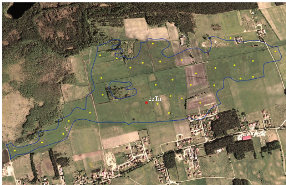
Rys. 2. Przykład konturu opisanego symbolami 2z Tn występowania gleb organicznych. Żółtym oznaczono lokalizacje punktów, z których pobrano próbki do analiz spektralnych; czerwony punkt oznacza lokalizację profilu wzorcowego
